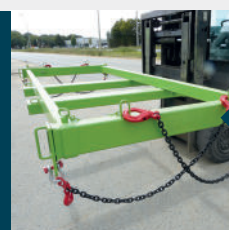
Chaînes maintenues après utilisation
