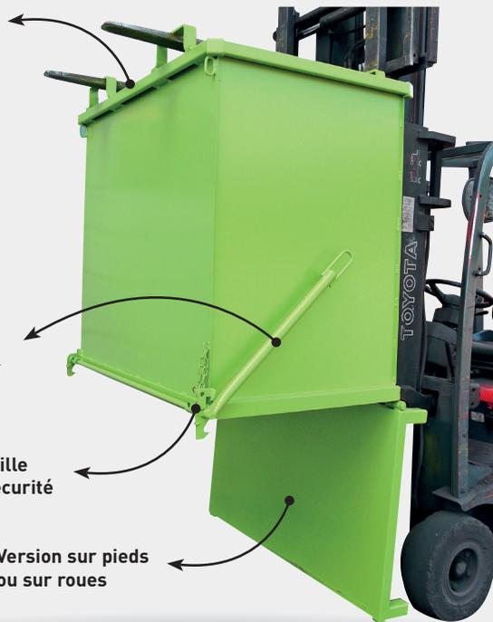
**! CONSEIL :** Contrôler que la hauteur de levée de mât de votre chariot soit suffisante (additionner cote K du tableau et hauteur de la benne collectrice). Vérifier la section et longueur de vos fourches - long. mini 1200 mm - si long. inférieure Nous consulter.
