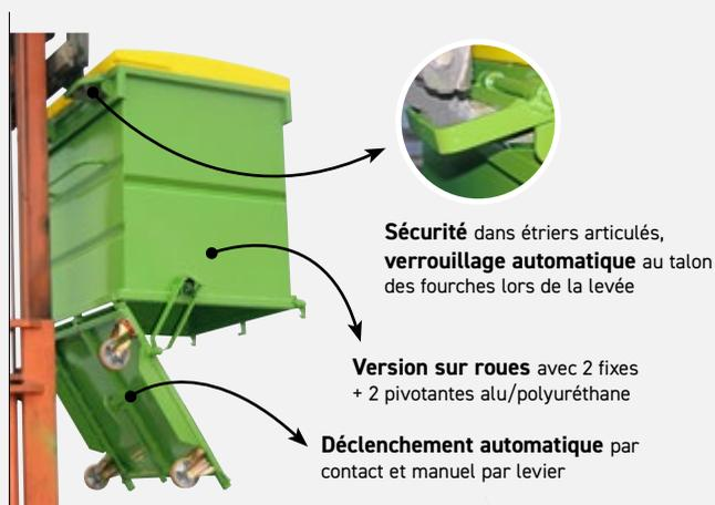
**CONSEIL :** Contrôler que la hauteur de levée de mât de votre chariot soit suffisante (ajouter cote K du tableau et hauteur de la benne collectrice). Vérifier la section et longueur de vos fourches - long. mini 1200 mm - si long. inférieure Nous consulter.
