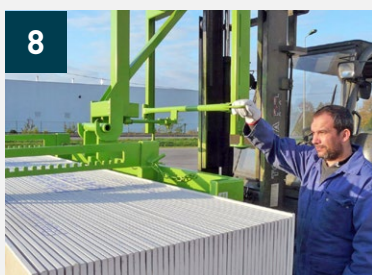
8 Clipsage du levier permettant le décrochage et retrait du palonnier
