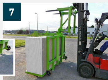
7 Chariot en position de déchargement avant retrait du palonnier PK
