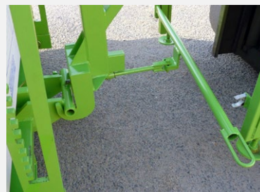
5 Préhension du chariot MP par le palonnier - Levier déplié pour verrouillage automatique du crochet sur le chariot MP sans intervention du cariste
