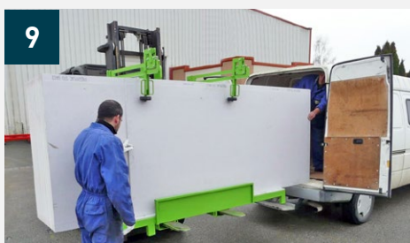
9 Chargement facilité par simple glissement des plaques vers la droite - Après distribution, bras de réglage à repositionner pour maintien des plaques restantes
