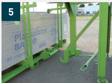
5 Préhension du chariot MP par le palonnier - Levier déplié pour verrouillage automatique du crochet sur le chariot MP sans intervention du cariste
