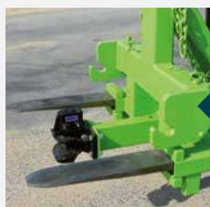
Flèche avec crochet automatique et fourreaux ouverts
