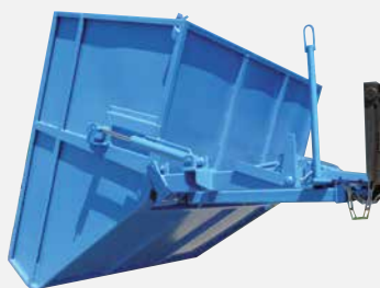
Vérin ralentisseur de fin de basculement (VRP)
