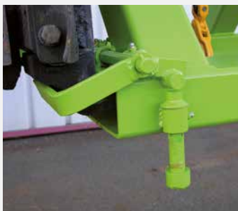
Blocage sur fourches (BFP)
