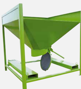
Sortie ronde, étanche par levier excentrique
