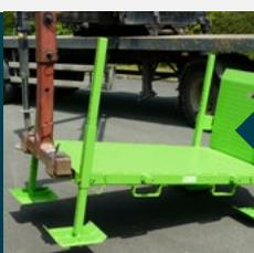
Déplacement à vide avec prise fourches dans fourreaux section 170x70 entraxe fixe de 700 mm
