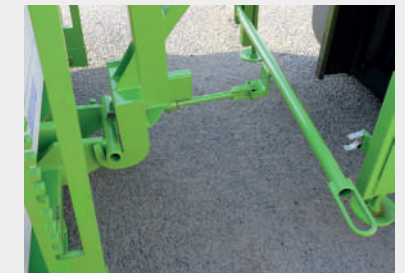
5 Préhension du chariot MP par le palonnier - Levier décliné pour verrouillage automatique du crochet sur le chariot MP sans intervention du cariste
