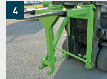
4 Prise du palonnier PK par le chariot élévateur
