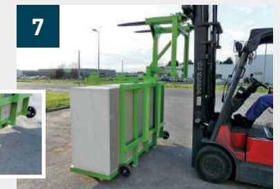
7 Chariot en position de déchargement avant retrait du palonnier PK
