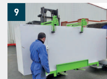
9 Chargement facilité par simple glissement des plaques vers la droite - Après distribution, bras de réglage à repositionner pour maintien des plaques restantes
