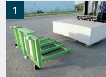
1 Chargement des plaques sur le chariot
