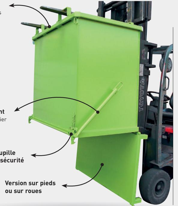
**! CONSEIL :** Contrôler que la hauteur de levée de mât de votre chariot soit suffisante (additionner cote K du tableau et hauteur de la benne collectrice). Vérifier la section et longueur de vos fourches - long. mini 1200 mm - si long. inférieure Nous consulter.
