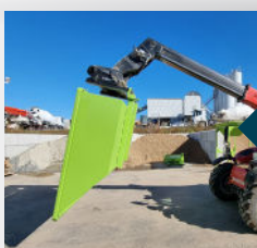
Position de vidage par inclinaison des fourches
