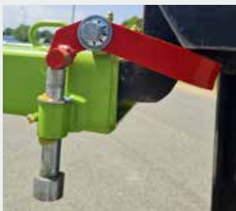
Blocage sur fourches (BFP)
