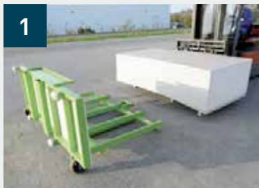
Chargement des plaques sur le chariot
