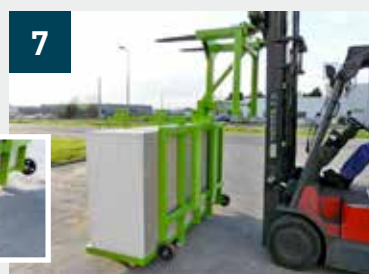
Chariot en position de déchargement avant retrait du palonnier PK
