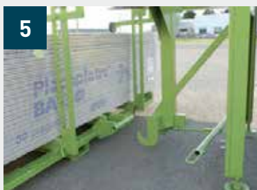
Préhension du chariot MP par le palonnier - Levier décliné pour verrouillage automatique du crochet sur le chariot MP sans intervention du cariste
