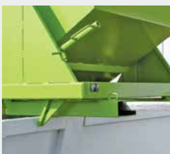
Déclenchement automatique (DAP) : en appui, par contact, avec barre d'appui
