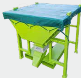
Trappe guillotine horizontale avec réduction goulotte
