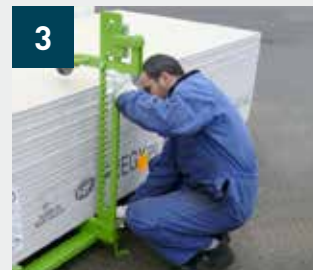
Pose des bras de retenue réglables
