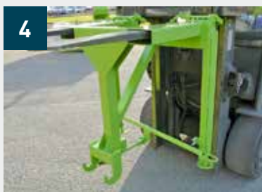
Prise du palonnier PK par le chariot élévateur
