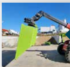
Position de vidage par inclinaison des fourches
