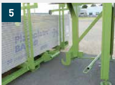
Préhension du chariot MP par le palonnier - Levier déplié pour verrouillage automatique du crochet sur le chariot MP sans intervention du cariste
