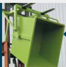
Vidage avec PL standard prise supérieure
