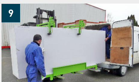
Chargement facilité par simple glissement des plaques vers la droite - Après distribution, bras de réglage à repositionner pour maintien des plaques restantes
