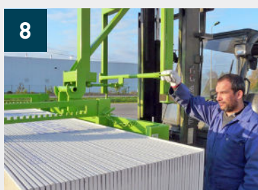
Clipsage du levier permettant le décrochage et retrait du palonnier
