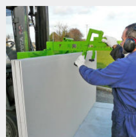
Chargement facilité par simple glissement des plaques vers la droite - Après distribution, bras de réglage à repositionner pour maintien des plaques restantes
